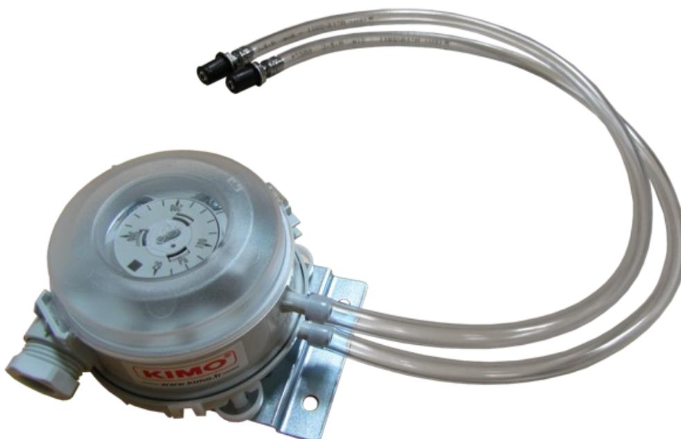
Les pressostats d'air différentiels à membrane sont utilisés pour la surveillance des installations de traitement d'air. Ils permettent, sans alimentation, d'établir un contact tout ou rien lors du dépassement d'une pression de consigne. Ils peuvent être montés en parallèle avec un manomètre.
