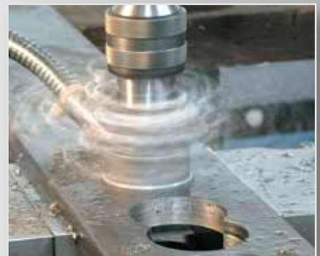
Bohren in Flachstahl
