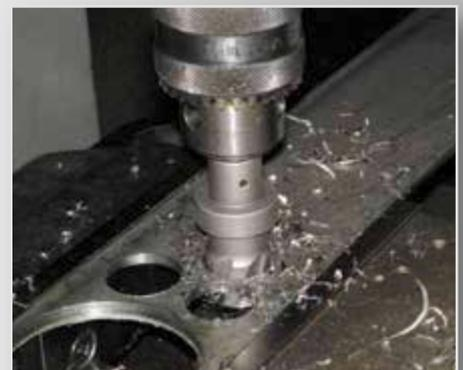
Bohren in Flachstahl
