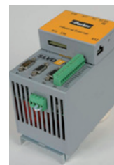
SLVD-N & EtherCAT box (option E5)
