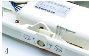
4 Custodia e coperchio sono chiusi ermeticamente e comandano lo spegnimento e la funzione di blocco dell'interruttore ex di distanza Enclosure and transparent shield are pressed tightly and drive the switching off and interlocking function of ex distance switch by unlocking device through interlock mechanism.
