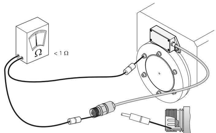
Elektrischen Widerstand zwischen Steckergehäuse und Maschine prüfen. **Sollwert:** 1 Ohm max.
